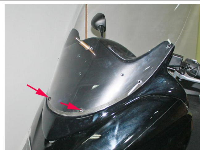
20. スクリーンを被せてこの時点では下の2本だけウェルナットで仮止めする。
