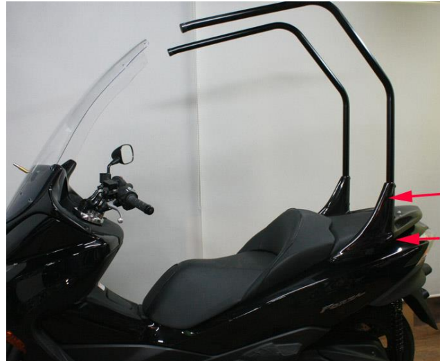
30. ウェルナットを使ってパイプ支柱を固定。 左右の区別に注意。
