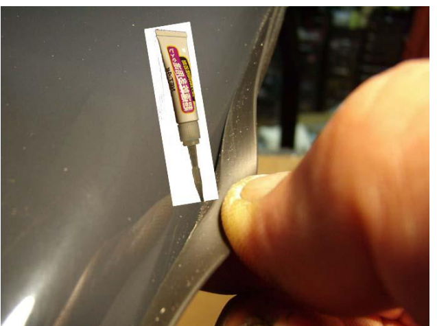
33. モールをめくって奥(下)へ15cm 間隔でごく微量点付。モールが波打たないよう、すぐに下から押さえる。
