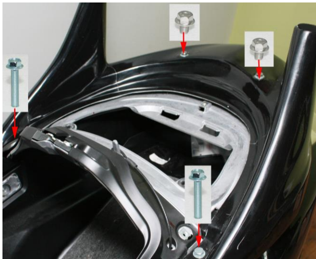
29. パイプ支柱ブラケットを取り付ける。
