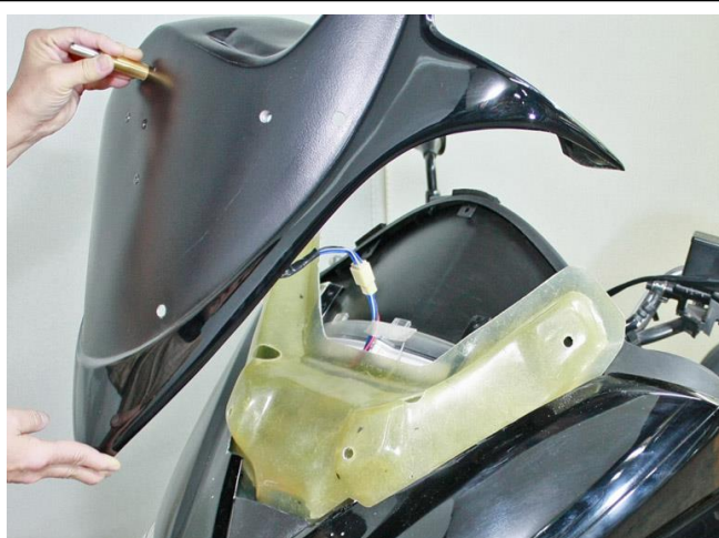
19. カプラーをしっかりとつないでからカウルを被せてモータの作動確認をする。 コードを挟まないよう注意する。
