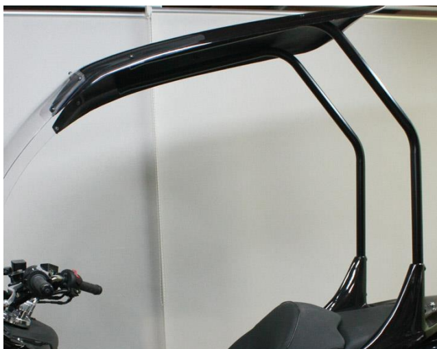
31. 支柱とルーフの接続もウェルナット。
