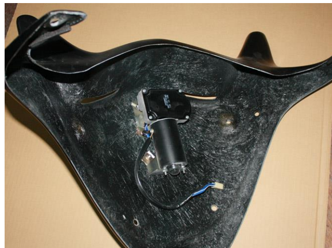
18. フロントカウルにモータを取り付ける。 ナットは細いドライバー等で適宜動かす。
