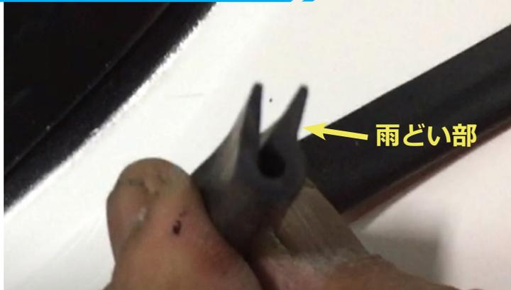
**55** 必ずレインモールの雨どい部分が外側になるように取り付ける
