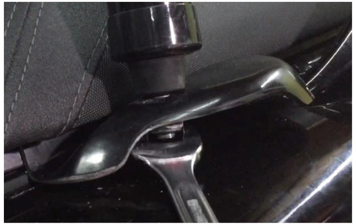
**62** ナットからボルトが1~2mm飛び出すまで締める
