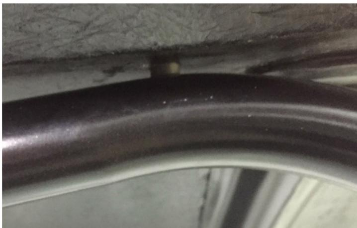
**49** ルーフと支柱の間に隙間がある場合は一度ウェルナットを緩めて締めなおす
