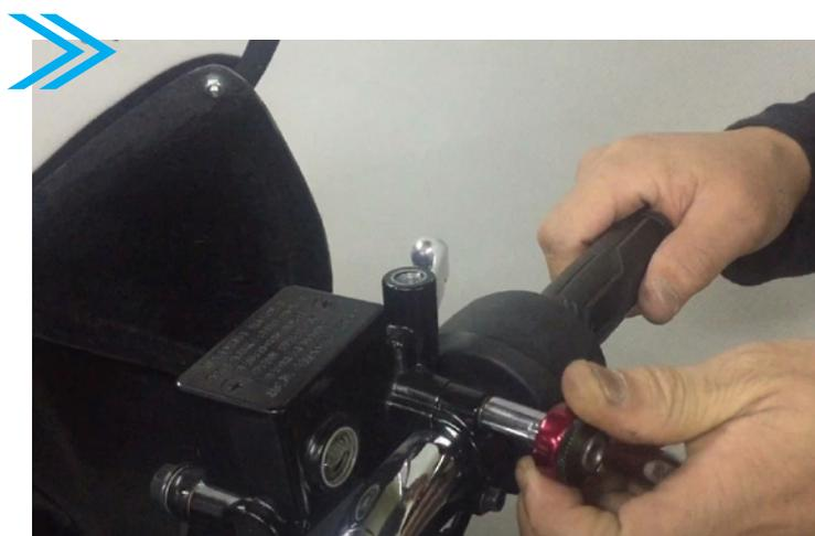
**82** ブレーキレバーがナックルバイザーと干渉するため、内側にずらし、少し下向きにする
