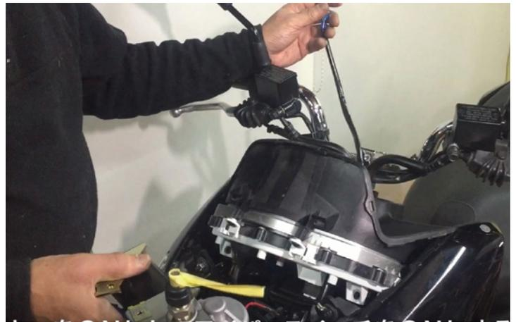
**16** キーをONにし、ワイパーをONにして作動を確認し、ワイパーをOFF、ワイパーシャフトが定位置停止したことを確認してキーをOFF、ワイパーモーターを取りはずす（必ず定位置停止させる）
