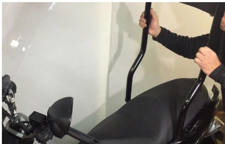
**50** 支柱下端のボルトを支柱ブラケットに差し込み
