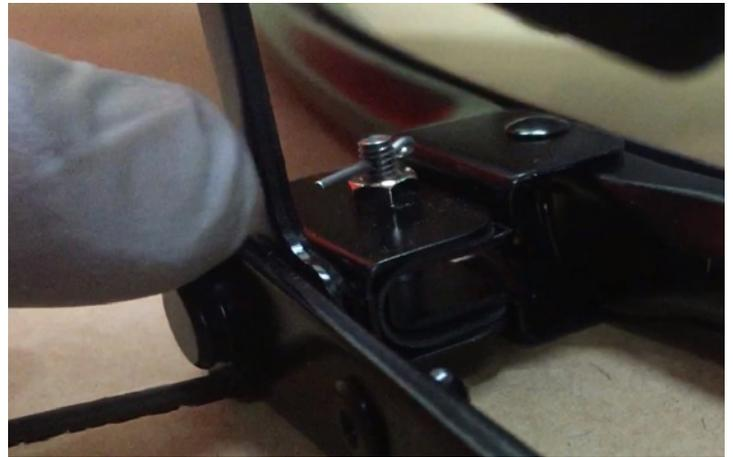
70 裏返してナットを取り付け、ビスの横穴に割りピンを差し込む
