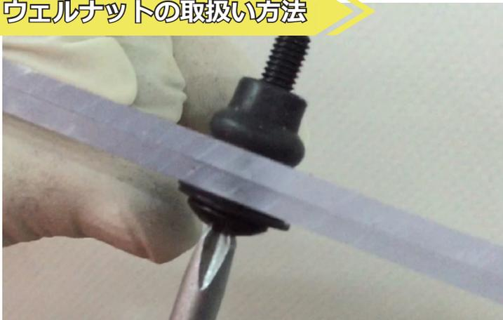
ウェルナットは締めるとゴムが膨らんで固定される。締める際には隙間が開かないように押さえて閉めること。
