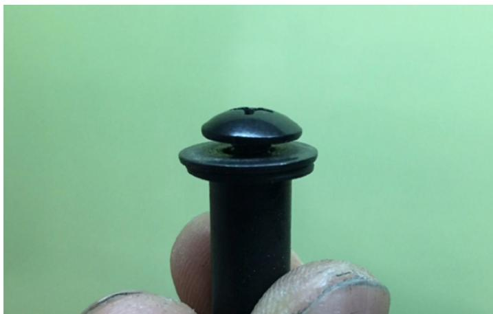
隙間が開いているまま穴に差し込むとウェルナットのツバが穴の内側に入り込んでしまい、振動や軋みの原因になるため注意する
