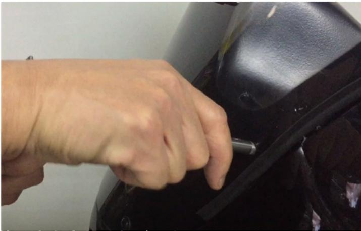
**63** 付属の調整棒でスクリーン、フロントカウル、フロントブラケットの穴を合わせる
