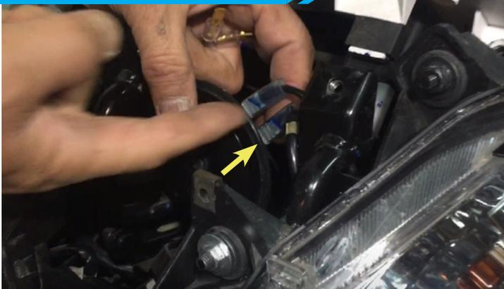
11 ホーンから分岐させてワイパーの電源をとる。矢印で示す線をホーンから抜く。
