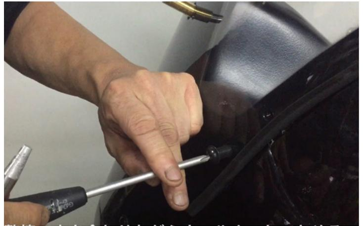
**64** ウェルナットで左右2ヶ所仮締めし、全てのウェルナットを本締めする
