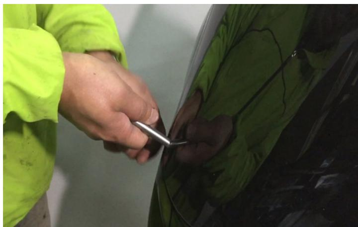
35 必要に応じて付属の調整棒を使用してスクリーンとフロントカウル、フロントブラケットの穴を合わせる
