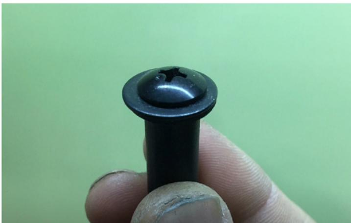
ウェルナットを穴に差し込む際は写真のようにビスとワッシャー、ウェルナット（ゴム部分）が隙間なくついている状態で差し込む。
