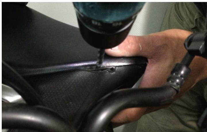
**86** フロントカウルを押さえながら開いている穴に合わせてバイク側に10mmキリで穴を開ける
