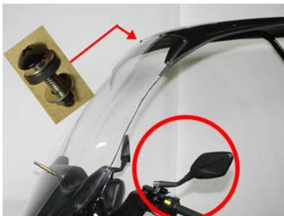
27. ルーフを乗せてウェルナットで固定。スクリーンとルーフの固定はビスを全て通してから中央から締めてゆく。スクリーンが浮き気味の場合は押し付けた状態で締める。(漏れ防止の為)
