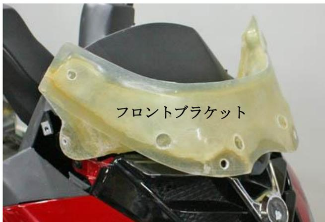
5. スクリーンの取り付け穴を利用してフロントブラケットを取り付けるので、各穴が合うよう被せる。
