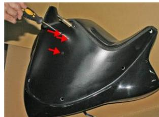
ナットがずれている時は細いドライバーなどで調整する。
