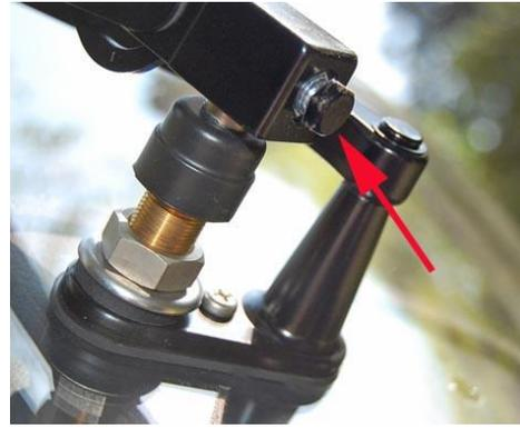
34. 一旦シャフトにしっかりとハマり込むまで緩めてから締める。このボルトが緩むとアームがずれた位置で動き、スクリーンやカウルを傷つけることになるので、しっかりと締める。
