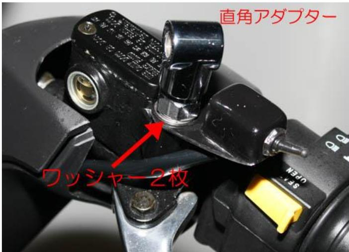
13. ワイパースイッチは直角アダプターでミラー根元に固定。ロックナットが回し易いようにワッシャー2枚使用する。
