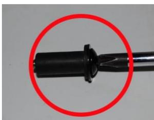
20. ウェルナットを差し込む時は図の様にナットのつばとビスの頭が当たった状態でドライバーを使って回さず押し込む。
