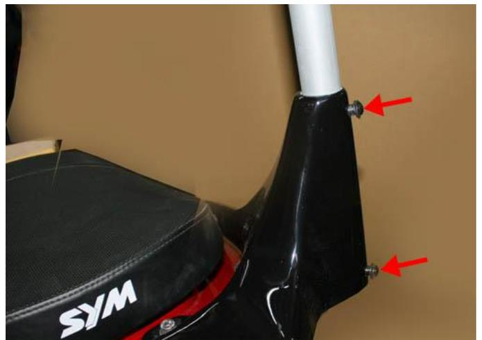
26. パイプ支柱をウェルナットで固定する。
