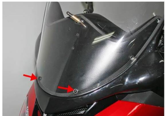
17. フロントカウル、スクリーンを被せ、穴を合わせてスクリーン上からウェルナットを挿し、軽く固定。(この時点では下の2本だけ)
