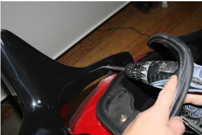
25. トランクのゴムモールを少しめくってパイプ支柱ブラケットの穴に合わせてタンデムグリップを10mm穴加工の後ウェルナットで固定。
