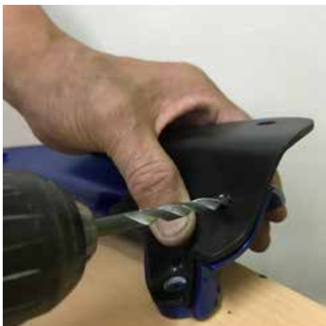
5. Grabバーの前方の穴のくぼみに支柱ブラケット を合わせ、(底の水抜き穴が合う向き) 支柱ブラケット の穴に合わせ6mmキリでGrabバーに穴をあける。
