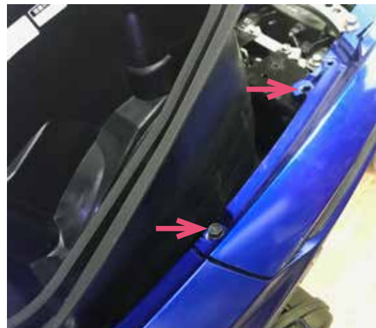
4. 矢印で示すビスを外し、 Grabバーを取り外す
