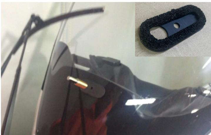
**62** 小判型のゴム板を取り付ける(スポンジの貼ってある側がスクリーンと接するようにする)
