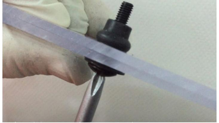
ウェルナットは締めるとゴムが膨らんで固定される。締める際には隙間が開かないように押さえて閉めること。
