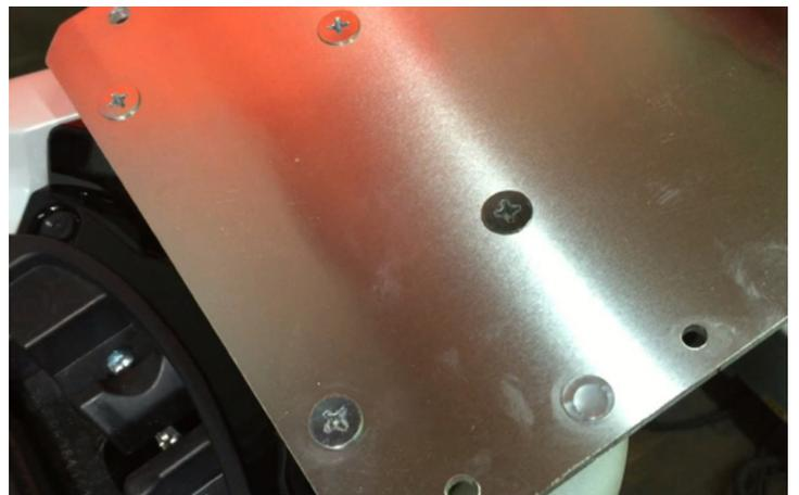
**37** リアボックス併用時はキャリアをスペーサーを使用してリアウイングカバー下の金具と併締めする（締めは太めのドライバー推奨）
