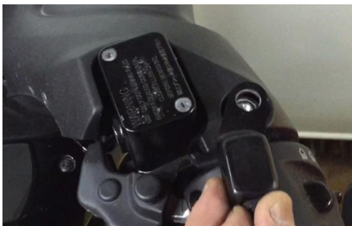
**19** ワイパースイッチをミラー根元に取り付けられるだけの長さの線を引き出しておく
