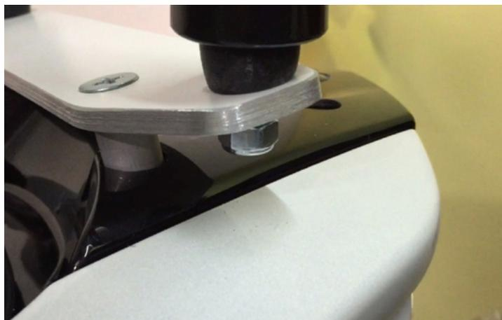
**51** 支柱下端のボルトをナットとワッシャーで締める
