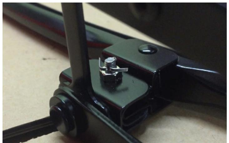
**61** 裏返してナットを取り付け、ビスの横穴に割りピンを差し込み、マイナスドライバー等で割りピンを左右に押し開く ※割りピンは必ず二股に分かれた側から入れる
