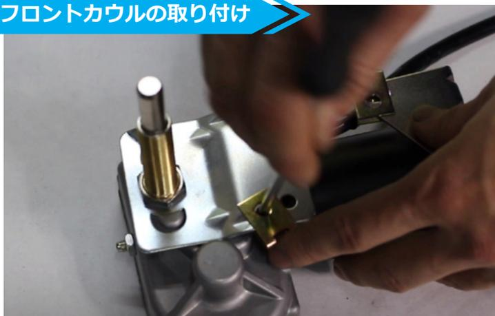
24 ワイパーモーターのクリップナットのずれをドライバー等で調整する
