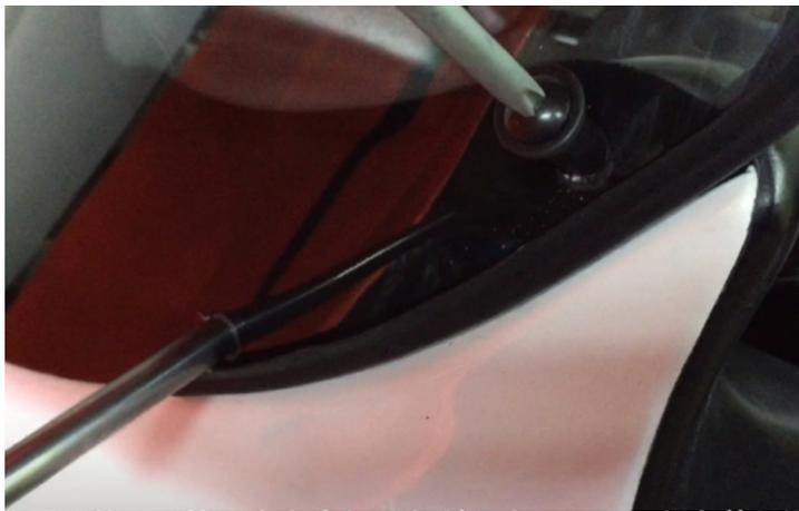
**58** フロントカウルを下から持ち上げ、フロントブラケットとの穴位置を合わせながらウェルナットを4つの穴に差し込む。全てのウェルナットを差し込んでから締める ※ドライバーの先を滑らせないように注意
