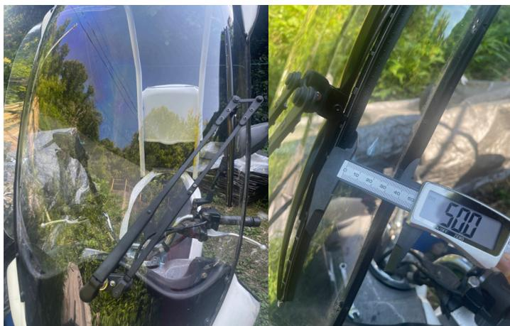
**65** ブレードを正面から見てスクリーン右端から50mmの位置に来るようにセットする
