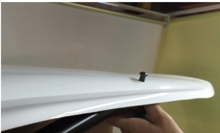
**50** 支柱下端のボルトを台座の穴に差し込み、支柱とルーフを接続する（4ヶ所）
