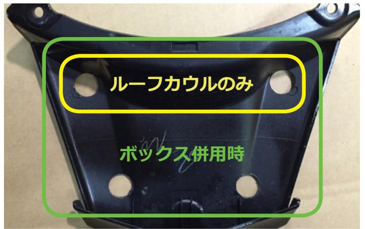
**33** ホールソーやステップドリルを使用して、ゾロリアボックス併用の場合は4ヶ所、併用しない場合は2ヶ所に18～20mmの穴を開ける（16mmのスペーサーが通るための穴）
