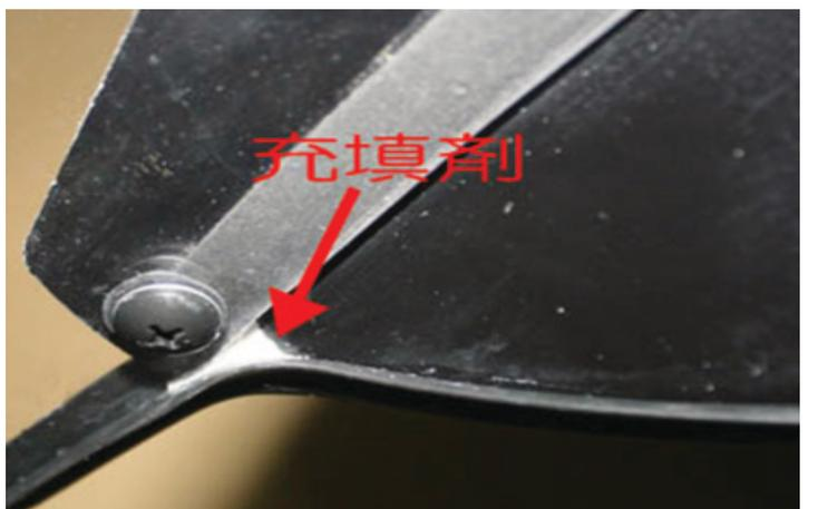
**75** スクリーンとルーフの接続部分のレインモールの隙間に充填材をつめる
