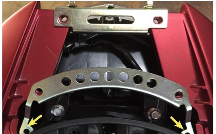
**35** 画像上の金具はそのままの位置において置き、下の金具はいったん取り出してリアウイングカバーに矢印の穴をクリップで止め、リアウイングカバーを元に戻す
