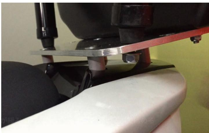
**42** 支柱下端のボルトをナットとワッシャーで締める
