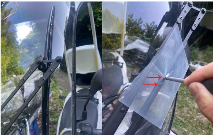
**67** ブレードが正面から見て垂直でない場合、矢印のビス2本を緩めアームの長さを調整して垂直にする。ビニール袋の切れ端など使ってビスを緩め、締めることで塗装剥がれ防止になります。
