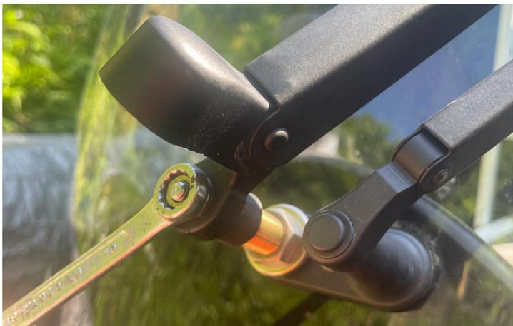
**66** シャフトにアームをセットし、ナットで締め付ける(10mm)
