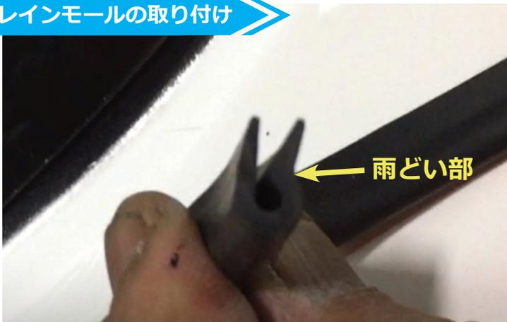
**52** 必ずレインモールの雨どい部分が外側になるように取り付ける
