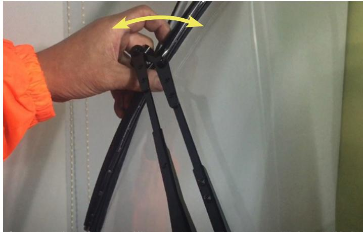
68 ワイパープレードの角度を調整して、ビスを締める
