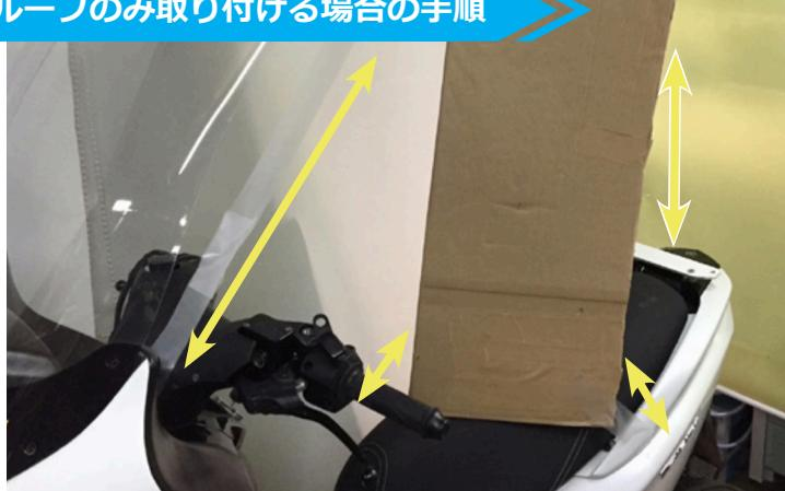
46 (1人で作業する場合) 梱包時のダンボール等を使用して写真のように支えを作り（高さ 1100mmにする）、前後左右を梱包用のガムテープ等で止める
