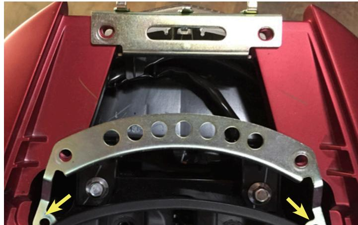
35 画像上の金具はそのままの位置において置き、下の金具はいったん取り出してリアウイングカバーに矢印の穴をクリップで止め、リアウイングカバーを元に戻す
