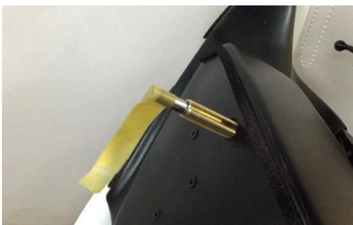
28 ワイパー モーターのシャフトにテープ等で目印をつけ、キーをON、ワイパー スイッチをONにして作動確認し、ワイパー スイッチをOFF、ワイパーが定位置停止したことを確認してからキーをOFFにする
