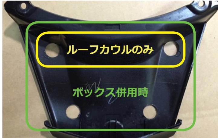
33 ホールソーやステップドリルを使用して、ゾロアボックス併用の場合は4ヶ所、併用しない場合は2ヶ所に18~20mmの穴を開ける（16mmのスペーサーが通るための穴）
