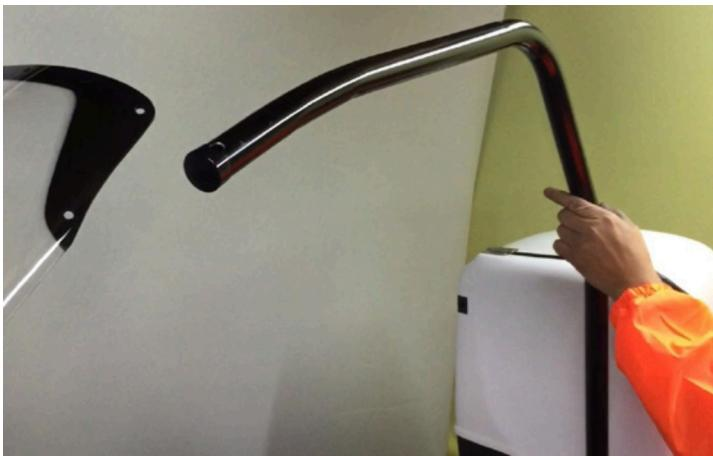
**40 支柱下端のナット、ワッシャーをはずして支柱の左右を間違えないように支柱のボルトをキャリアの穴に差し込む（支柱は左右で穴の位置が違うため注意。ルーフ接続用の穴が外側を向くようにする。）**
