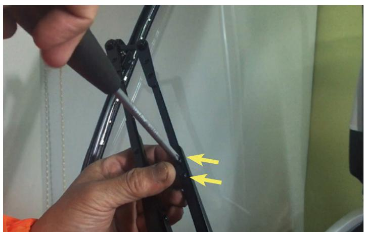
67 ブレードがスクリーンと平行でない場合、写真的位置のビスを緩めて
