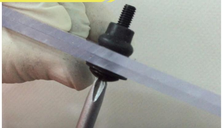
ウェルナットは締めるとゴムが膨らんで固定される。締める際に隙間が開かないように押さえて閉めること。
