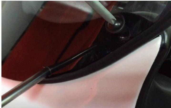
58 フロントカウルを下から持ち上げ、フロントブラケットとの穴位置を合わせながらウェルナットを4つの穴に差し込む。全てのウェルナットを差し込んでから締める ※ドライバーの先を滑らせないよう注意
