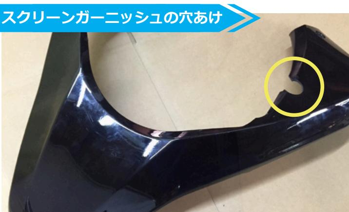
10 写真の位置にステップドリルやホールソーを使用して配線用の 18 ~ 20 mm の穴を開ける
