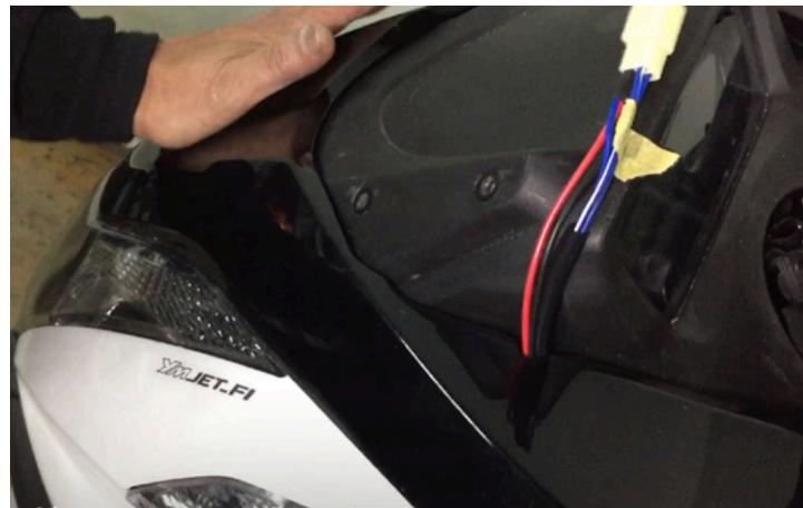
15 ワイパースイッチ線を 12 項で加工した切り欠き部分に納め写真の位置を押さえてスクリーンガーニッシュをはめ込む（線を挟まないように注意する）
