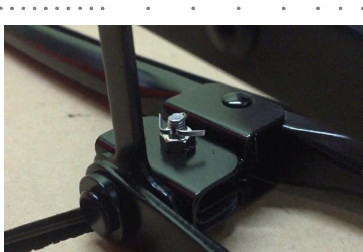
61 裏返してナットを取り付け、ビスの横穴に割りピンを差し込み、マイナスドライバー等で割りピンを左右に押し開く
